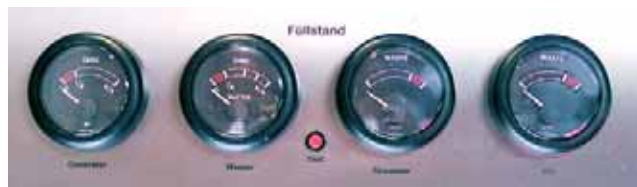
Tankanzeigen im Controlpanel
