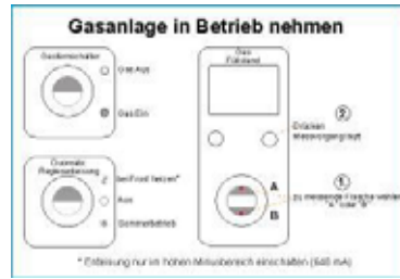
Aufkleber für Bedienung Gasanlage
