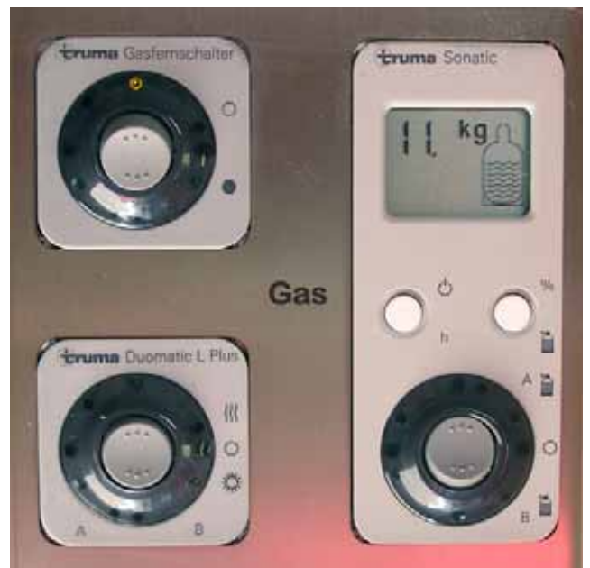
Steuerung der Gasanlage im Controlpanel
