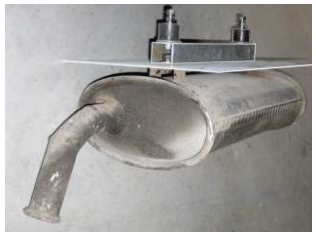
Generatorauspuff, geänderte Aufhängung
