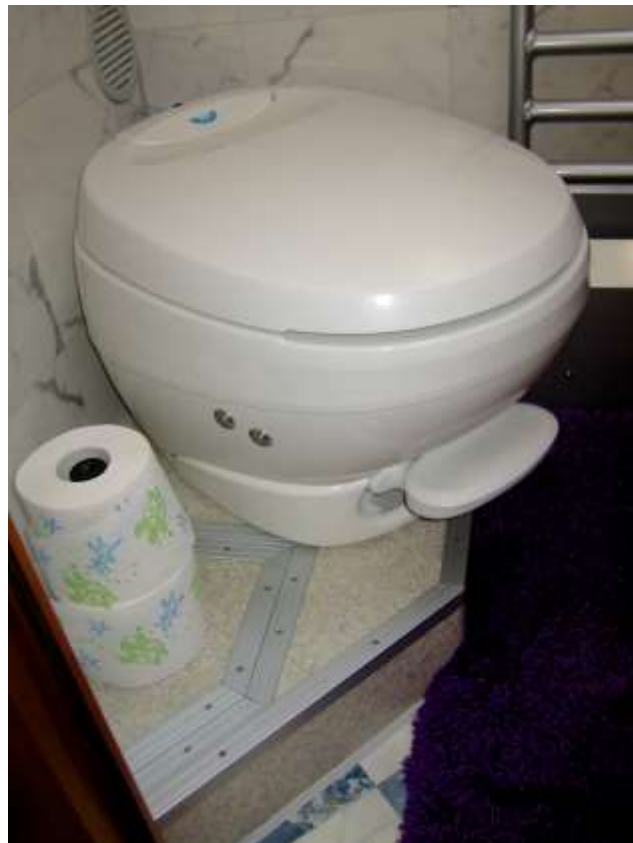
Toilette mit seitlich angebrachten Funktionstasten für Wasserspülung und Pumpe/Häcksler-Betrieb
