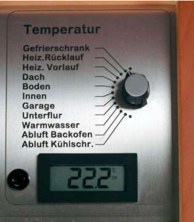
Temperaturüberwachung im Controlpanel
