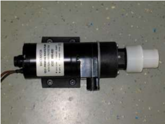
Neue defekte Häckslerpumpe
