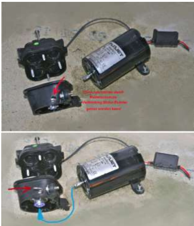
Bohren eines Loches, damit der Pumpenkopf vom Motor gelöst werden konnte.
