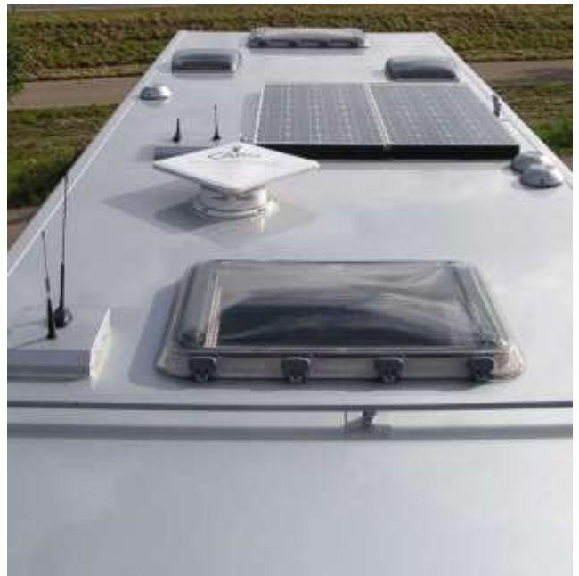
Dachaufbauten von vorne gesehen
