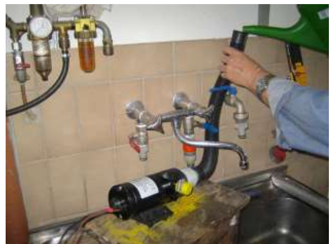
Simpler Pumpentest mit eingefülltem Wasser
