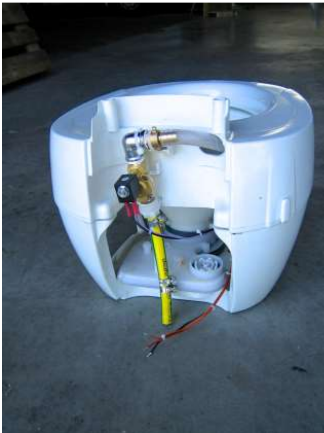
Toilette umgerüstet auf elektrische Spülung
