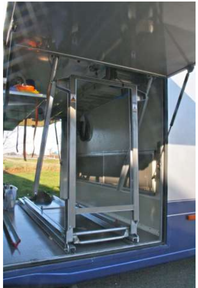
Garage umgebaut mit pneumatischer Hebevorrichtung
