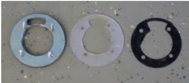
Anfertigung einer neuen Dichtung
