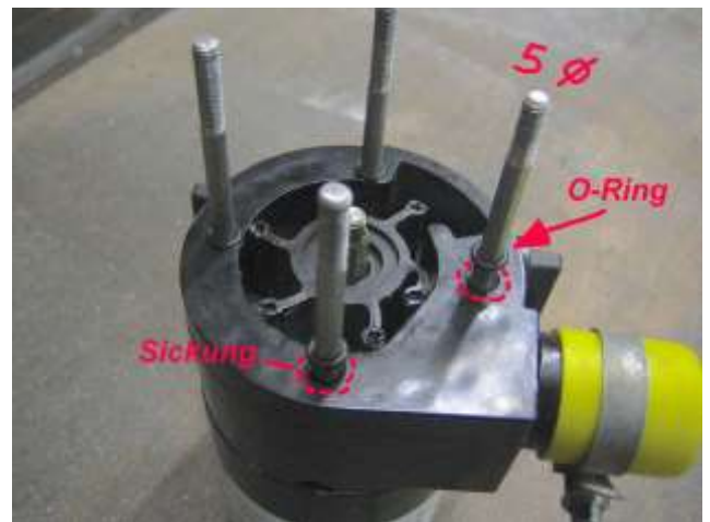
Die Lösung, zusätzliche Abdichtung durch O-Ringe
